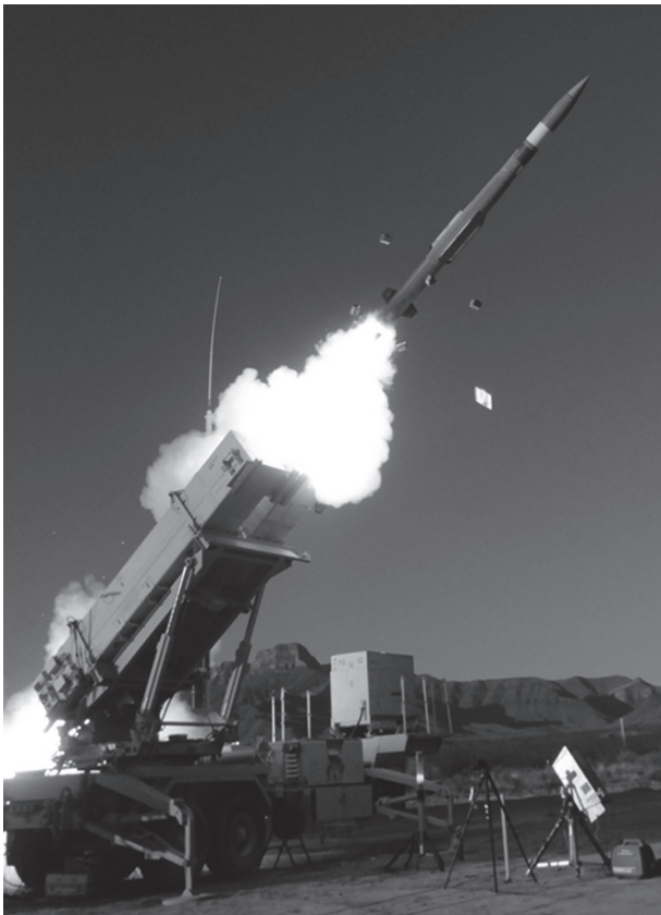
対処面積が2倍になるPAC-3の能力向上型MSEミサイルの発射 (提供：ロッキード・マーティン)
