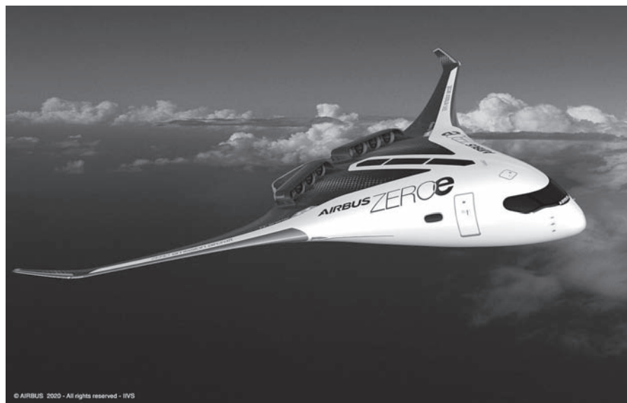
水素燃料を活用したブレンデッド・ウィング・ボディ機のイメージ機のイメージ(提供:エアバス)
