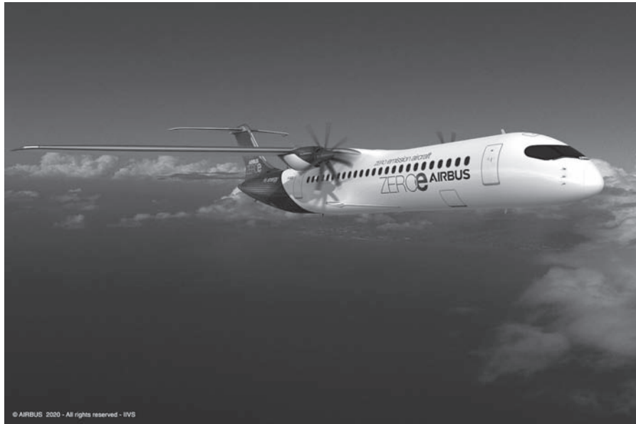
エアバスが発表した水素燃料旅客機のコンセプトの一つ。画像はハイブリッドターボプロップエンジンのイメージ(提供:エアバス)
