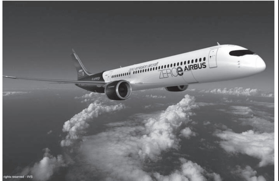
エアバスが発表した水素燃料旅客機のコネプトの一つ。画像はハイブリッドターボファンエンジンを搭載するターボファン機のイメージ(提供:エアバス)
