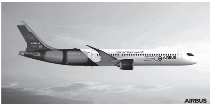
水素燃料旅客機のコンセプトにおける水素燃料タンクの配置イメージ(提供:エアバス)
