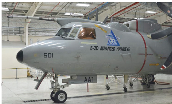
初飛行した空中給油装置付きのE-2Dの1機。操縦席の上方から空中給油プローブが突き出ている (提供：ノースロップ・グラマン)
